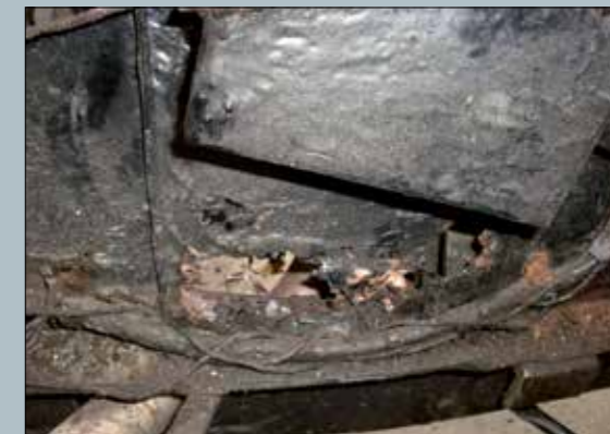
Viel Rost und verrottete Bleche auch an der Karosserie. Beaucoup de rouille également sur la carrosserie.
