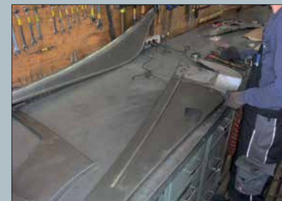
Viele Bleche mussten neu angefertigt und angepasst werden. Beaucoup de tôles ont dû être remplacées à neuf et réajustées.
