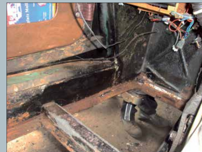
Rost, Rost, Rostlöcher überall. Eine Folge des nicht vorhandenen Rostschutzes ab Werk und natürlich auch der fast 50-jährigen Verwendung.
