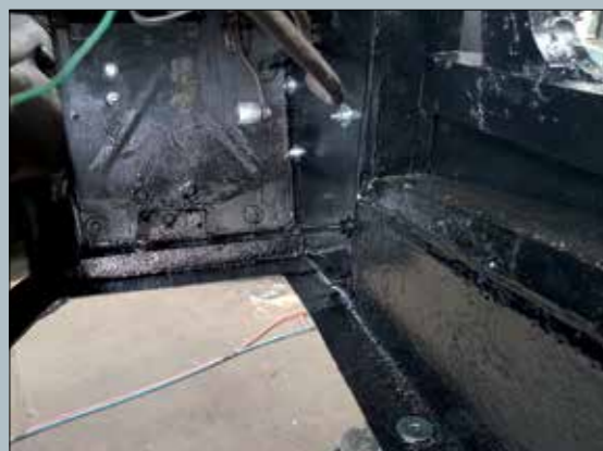
Das Endresultat der Chassisüberholung nach vielen Stunden. Die schwarze Schutzfarbe ist einerseits Epoxy-Grundierung, andererseits 2-Komponenten-Lack.
