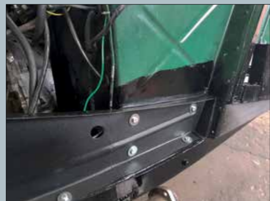
Résultat de la révision du châssis après beaucoup d'heures de travail. Couche de fond époxy et peinture 2 composants.
