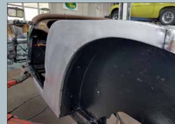
Viele Bleche mussten neu angefertigt und angepasst werden. Beaucoup de tôles ont dû être remplacées à neuf et réajustées.
